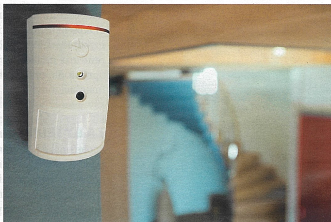
Jádro alarmů (zde JABLOTRON 100+) představují nejrůznější senzory a detektory
